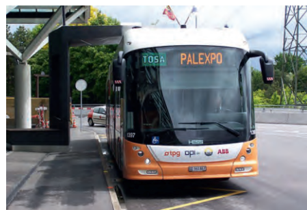
Bus du projet « Tosa » à l'arrêt le temps de la recharge (système sans caténaire). Genève
